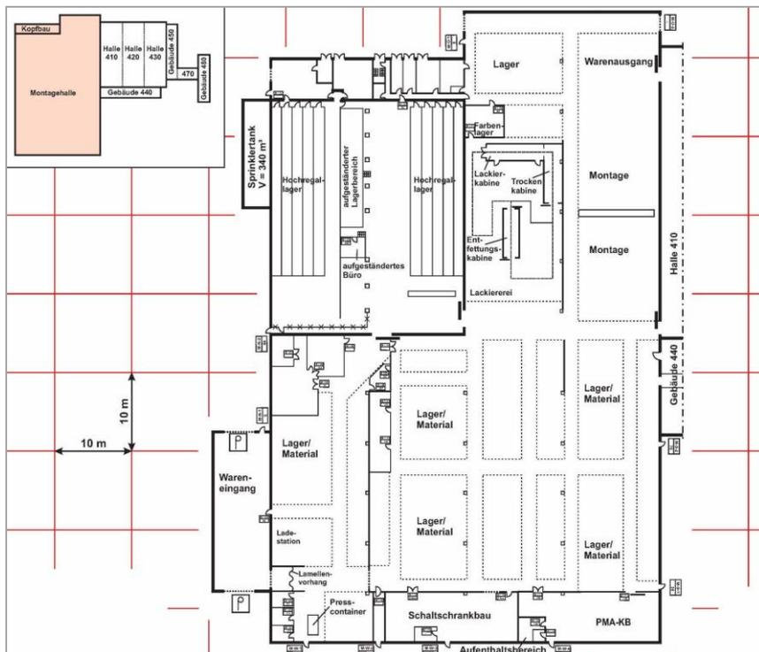
**Grundriss Erdgeschoss – Montagehalle / Hochregallager / Kopfbau**
