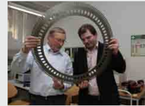
Die Motorkühlung besteht aus mehreren übereinander gelegten Aluminiumscheiben. (Foto: Stephan Thomas)
